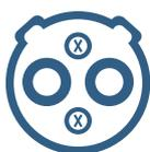
**CHAdeMO (Charge de Move):** CHAdeMO ist wie das Combined Charging System (CCS) ein Stecker für Schnellladevorgänge bis 150 kW. Dieser Stecker kommt aus Japan und wird hauptsächlich im asiatischen Raum und bei asiatischen Autos verbaut. Der CHAdeMO-Ladestecker ist nicht kompatibel mit dem Ladestecker des CCS-Ladesystems. Für Tesla gibt es jedoch Adapter von CHAdeMO auf Typ-2.
