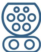
**CCS-Stecker Combo 2:** Das CCS (Combined Charging System) ist ein kombiniertes Schnellladesystem nach europäischem Standard. Hierbei ist der Typ-2-Stecker um zwei Schnellladeanschlüsse erweitert und kann bis 350 kW verwendet werden. Ein CCS-Stecker wird für DC Laden mit Gleichstrom verwendet. Dieses Steckverbindingssystem ist mit dem Typ-2-Stecker kompatibel.
