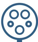
**Typ-1-Stecker:** Der Typ-1-Stecker ist ein Einphasen-Ladestecker für Ladungen bis zu einer Ladeleistung von 7,4 kW (bei 230 V und 32 A) Wechselstrom. Er wird von europäischen Herstellern seit 2017 nicht mehr eingesetzt. Mit einem passenden Kabel kann jedoch weiterhin mit Typ-1-Stecker geladen werden.
